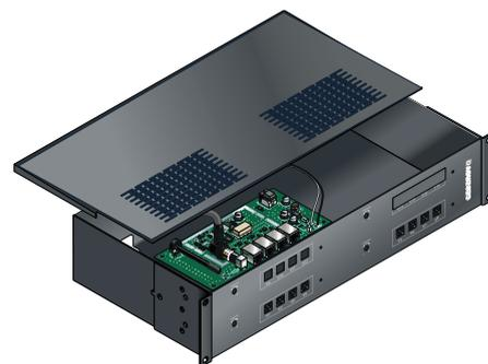
Refermez le capot en le revissant en face arrière, Branchez le Switch TV Optique à l'alimentation électrique. La LED témoin rouge s'allume.
